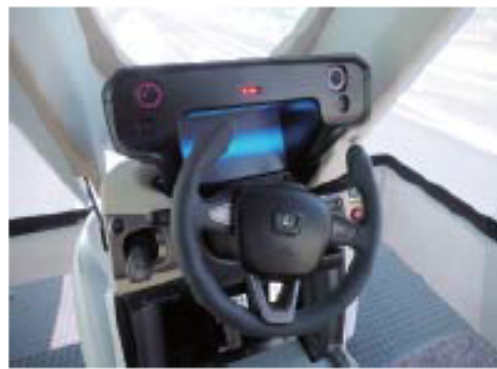
■3Dメガネに取り付けられたターゲット（左）。ダッシュボードの上部にはターゲットの位置を追跡するセンサーがある（右）
